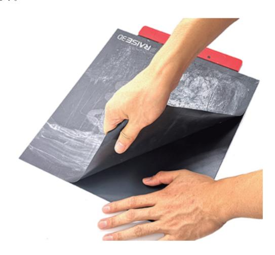
②古いビルドサーフェスを剥がした後にビルドプレートに接着剤が残っている場合は、スクレーパーで慎重に清掃します。表面は削らないでください。
