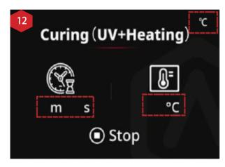
乾燥が終わると、表示画面は図 12 に示すように硬化インターフェースに入ります。残りの硬化時間は左側の赤いボックスに表示され、目標温度は右側の赤いボックスに表示され、現在のチャンバー温度は右上の赤いボックスに表示されます。
