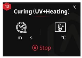
硬化を途中で止めたい場合は、ノブを回して Stop を選択し、ノブを押してください。
