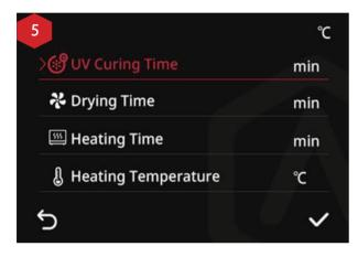
調整終了後、ノブを押して次のパラメータ設定に移ります。先ほどと同様にノブを回し、Drying Time(乾燥時間)、Heating Time(加熱時間)、Heating Temperature(加熱温度)のパラメータを順に調整します。
