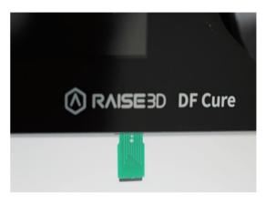
5, TF カード延長アダプタを挿入した状態で、DF Cure の電源を入れると、自動でフォームウェアの更新がされます。表示ディスプレイ上に **…END** が表示されれば更新は完了です。
