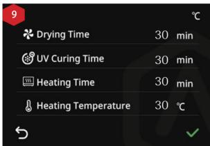
すべてのパラメータ調整が完了したら、ノブを回して**✓**選択します。DF Cure は、あらかじめ設定されたパラメータに従い、乾燥・硬化(UV+加熱)の順に動作します。
