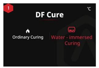
ノブを回してホーム画面の Water - immersed Curing(水浸硬化)オプションを選択し、ノブを押して水浸硬化モードに入ります。
