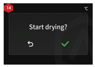
フロントドアを閉めると、自動でディスプレイ 画面に「Start drying?」が表示されますので、ノ ブを回して緑色の**▽**を選択し、乾燥を開始して ください。
