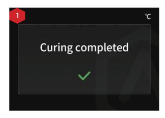
通常の硬化または水浸硬化が全て終了すると、表示画面に「Curing completed(硬化完了)」と表示され、DF Cure から警告音が鳴り、動作が停止します。ノブを押すと、表示画面からホーム画面に戻ります。
