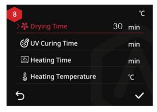
調整終了後、ノブを押して次のパラメータ設定に移ります。先ほどと同様にノブを回し、UV During Time(UV 硬 化 時 間)、Heating Time(加熱時間)、Heating Temperature(加熱温度)のパラメータを順に調整します。UV 硬化時間の範囲は  $0 \sim 60$  分です。加熱時間の範囲は  $0 \sim 300$  分です。加熱温度範囲は  $60 \sim 120$  です。
