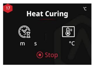
熱硬化を途中で止めたい場合は、ノブを回して Stop を選択し、ノブを押してください。
