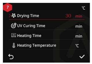
ノブを回して乾燥時間を調整します。時間の 範囲は0~30分の範囲で調整可能です。
