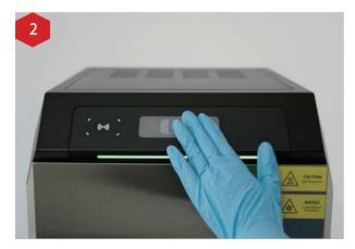
庫内温度が60℃以下になるまで待ち(現在の 庫内温度はディスプレイ画面の右上に表示されます)、上部の接触式センサーに触れ、フロントドアを開けます。
