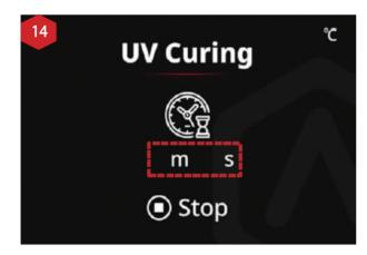
UV 硬化のみが必要な場合は、Heating Time (加熱時間)を 0 に設定していてだくと UV 硬化のみが可能です。
