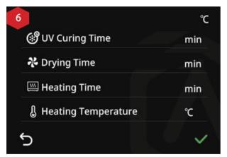
すべてのパラメータ調整が完了したら、ノブを回して✓選択します。DF Cure は、あらかじめ設定されたパラメータに従い、UV 硬化、乾燥、熱硬化の順に動作します。
