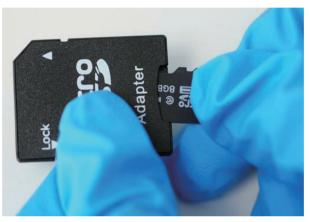
2, マイクロ SD カード変換アダプターから最新ファームウェアが入っている TF カードを取り出し、取り出した TF カードを TF カード延長アダプターに挿入します。
