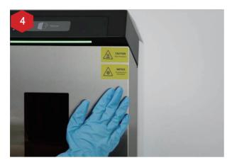
上記の2つのモードから1つを選び、硬化前の モデルをトレイに設置し、フロントドアを閉め ます。
