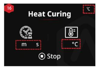
熱硬化のみが必要な場合は、UV Curing Time (UV) 硬化時間)を0 に設定していてだくと熱硬化のみが可能です。
