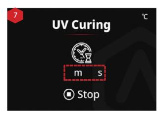
動作が始まると、硬化インターフェースに移動し、残りの硬化時間が赤枠部分に表示されます。
