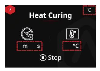
乾燥が完了すると、熱硬化のインターフェースに移ります。図 17 に示すように残りの硬化時間は左側の赤いボックスに表示され、目標温度は右側の赤いボックスに表示され、現在のチャンバー温度は右上の赤いボックスに表示されます。
