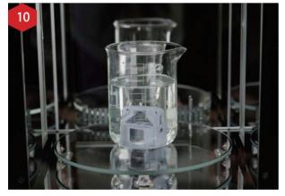
硬化が完了したモデルを取り出してください。
