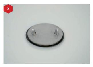
トレイの底にある 2 つの円柱状のピン(図 3) とチャンバー内のモーター・トランジション・ ブロックにある 2 つのスロット(図 4)を確認し てください。
