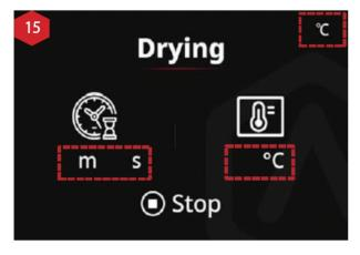
表示画面は図 10 に示すように乾燥インターフェースに入ります。残りの乾燥時間は左側の赤いボックスに表示され、目標温度 (50° C に固定) は右側の赤いボックスに表示され、現在のチャンバー温度は右上の赤いボックスに表示されます。庫内温度が目標温度 (50° C) に達すると、DF Cure の乾燥が開始され、残りの乾燥時間がカウントダウンされます。
