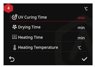
ノブを押して、UV 硬化時間オプションに入り、ノブを回してこのパラメータの時間を調整します。
