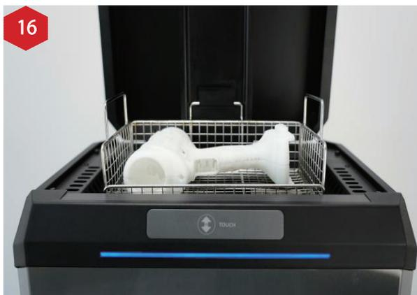
洗浄が終了すると、Z 軸昇降アセンブリは洗浄槽から自動で上昇します。Z 軸昇降アセンブリが終了位置に達すると、ファンが作動してモデルを乾燥します。
