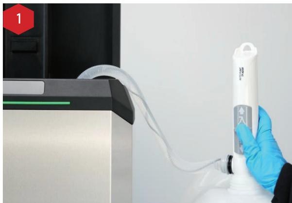
電動サイフォンポンプのスイッチを上を押すと、電動サイフォンポンプが自動的に洗浄材の容器から洗浄槽に洗浄溶剤を送り込みます。液面がオーバーフローボックスの最低液面マーク（図2の赤枠）に達すると、電動サイフォンポンプは自動的に洗浄溶剤の注入を停止します。電動サイフォンポンプのスイッチを下に押し、ポンプが停止します。
