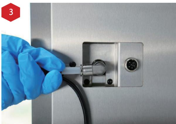
次に、図3に示すようにドレインツールのもう一方の端子を DF Wash 背面のホースコネクターへ接続します。ホースコネクターへの接続の際は、図3の赤枠で示した黒いロックリングにしっかりと嵌まるようにしてください。
