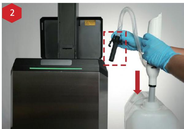
Z 軸昇降アセンブリから洗浄かごを取り外した後、図 2 に示すように、片手で電動サイフォンポンプの入口側を洗浄溶剤の容器に挿入し、もう一方の手で電動サイフォンポンプの出口側（黒い部分）を洗浄槽へ入れてください。
