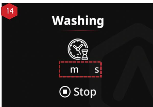
DF Washが洗浄動作を開始すると、Washing（洗浄）インターフェースが表示されます。図14の赤枠の位置が残りの洗浄時間を示しています。
