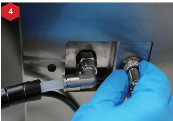
図2の赤丸に示すように、ドレインツールのボタンを押しながら、ドレインツールのヘッド（ホースの一端と液面検出針を含む）をキャップに差し込みます。
