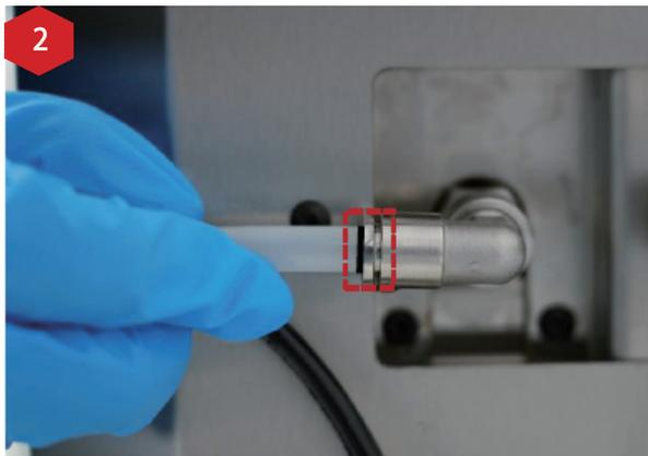
D. それでも液漏れがある場合は、洗浄液が全て廃液処理タンクに排出され、DF Wash がスタンバイモードになるのを待ってください。その後、図1の赤丸のように、ロックリングを右に動かしてクイックコネクターのナットに近づけ、ホースを引き抜きます。
