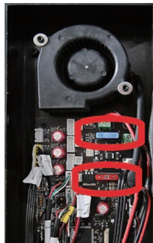
B メインボードに挿さしている青いヒューズと赤いヒューズを取り外し、確認してください。
